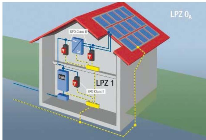
Рис. 1: Принципиальная схема из стандарта IEC 60364-7-712
