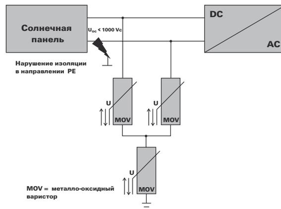
Рис. 4: Y-образная защитная схема с тремя варисторами
