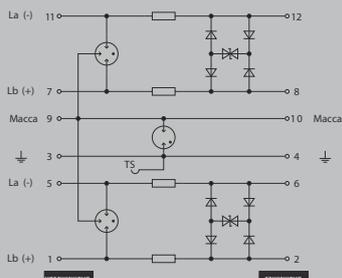
Комплектный модуль, не прямое заземление
