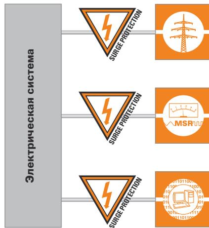
Основополагающим требованием для организации эффективной защиты от перенапряжений является наличие исправного эквипотенциального соединения по стандарту DIN VDE 0100 часть 540, имеющего вид последовательного соединения, а еще лучше, соединения звездой или в форме решетки.
