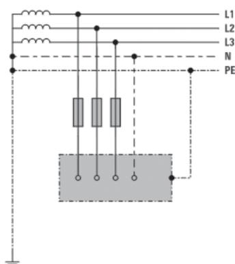
Открытые проводящие части электрической установки заземляются.
