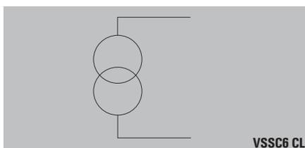
Устройство **VSSC6 CL** является комбинированной двухступенчатой защитой с оградительным диодом между токовыми цепями. VSSC6 CL ограничивает перенапряжение в **одной цепи аналоговых сигналов** (например, токовая петля). Потенциал PE обеспечивается в точке подключения 3/6 путем фиксации клеммы на заземленной DIN-рейке. Это позволяет подключить соединение экрана. Этот вариант предлагается также в виде защитной схемы с плавающей землей **VSSC6 CL FG**.
