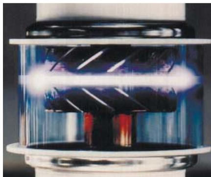
Электрическая дуга в 10 кВ выключателе при выключении
