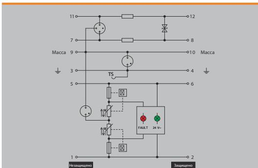
Комплектный модуль, не прямое заземления
