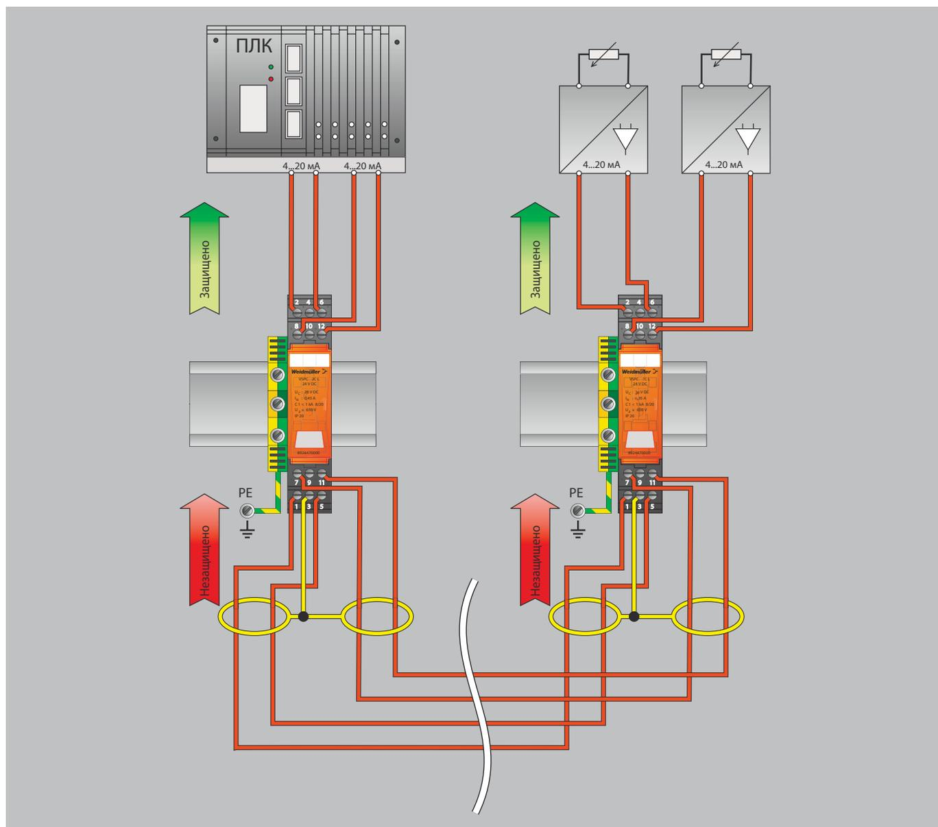
**Защита от перенапряжения для датчиков с напряжением питания и с токовой петлей 0 (4)...20 мА**
