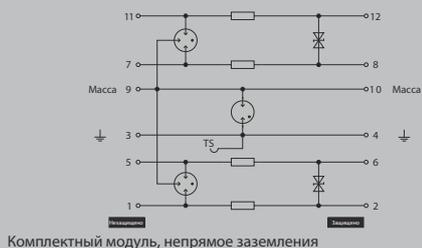
Комплектный модуль, не прямое заземления
