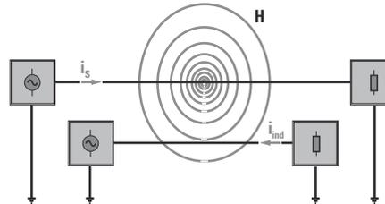
При грозовом разряде с большой силой тока создается сильное магнитное поле. После этого перенапряжения достигают ближайших цепей посредством индуктивного влияния (например, по напрямую заземленным проводам, силовым линиям, линиям передачи данных и т. д.). В соответствии с принципами работы трансформаторов связь наведенных напряжений является значительной из-за  $di/dt$  высокочастотного тока – даже при наличии только одной первичной и одной вторичной обмотки, т. е. при низкой индуктивности.
