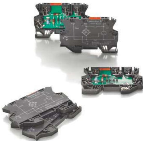
Данные клеммы обеспечивают трехступенчатую защиту от перенапряжений и оснащаются газовыми разрядниками, варисторами, оградительными диодами (TAZ) и индуктивными развязками. Завершают этот ряд отдельные защитные компоненты, такие как варисторы и оградительные диоды.
