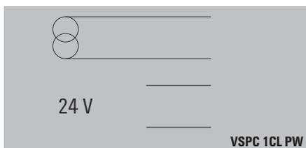
**Компонент VSPC 1CL PW (электропитание и сигнал 1CL)** обеспечивает в одном устройстве комбинированную защиту для источника питания 24 В пост. тока и токовых петель. Это устройство VSPC защищает датчики с дополнительным источником питания 24 В пост. тока.
