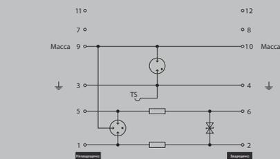
Комплектный модуль, не прямое заземление
