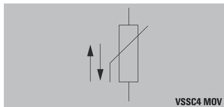
Устройство **VSSC4 MOV** обеспечивает одноступенчатую защиту с варистором (MOV) для цепи тока на контакт PE. **VSSC4 MOV** ограничивает перенапряжение в **одной цепи** (например, для электромагнитных клапанов). Варистор MOV с тепловым контролем предлагается для напряжений 12 В, 24 В, 48 В, 60 В, 120 В, 150 В и 240 В.
