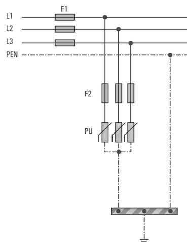
Предохранитель F2 обеспечивают защиту от коротких замыканий УЗИП. Эти предохранители должны выбираться с учетом номинального тока, указанного в инструкциях по монтажу производителя УЗИП. Использование предохранителя F2 не требуется, если характеристики предохранителя F1 (является частью электрической установки) соответствуют комбинации номинальных токов, указанных производителем УЗИП.
