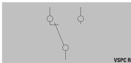
Если модуль VSPC с маркировкой "R" вставлен в соответствующий цоколь "R", с помощью двухполюсного штекера можно использовать функцию оповещения об отключении. Это винтовое/вставное соединение имеет диапазон сечений зажимаемого провода от 0,5 до 1,5 мм<sup>2</sup>.
