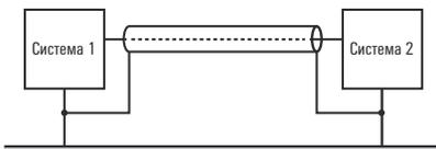
Высокоомное сопротивление с одной стороны экрана рекомендуется, когда пытаются не допустить образования контура заземления в случае экранов, подсоединенных с обеих сторон.
