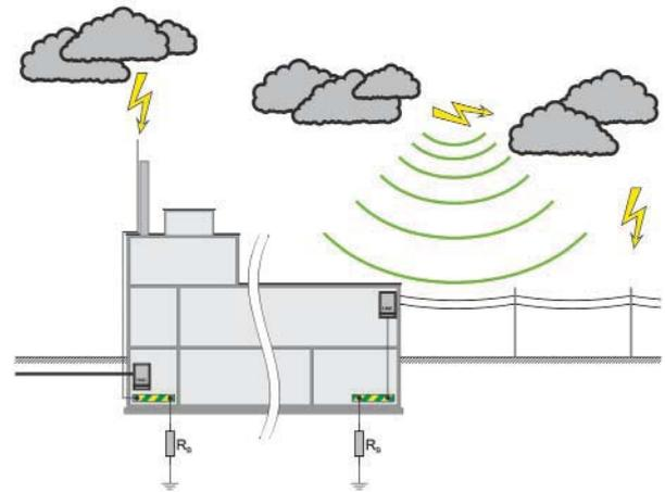
к воздействию импульсного напряжения должна составлять 6 кВ. Именно на этом участке должно производиться подавление высокоэнергетических перенапряжений в соответствии с концепцией зонирования молниезащиты и в связи с физическими условиями.
