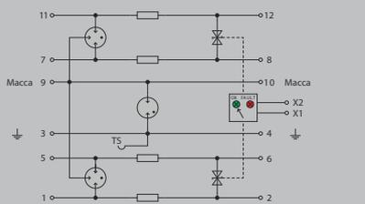
Комплектный модуль, не прямое заземление, с дистанц. оповещением
