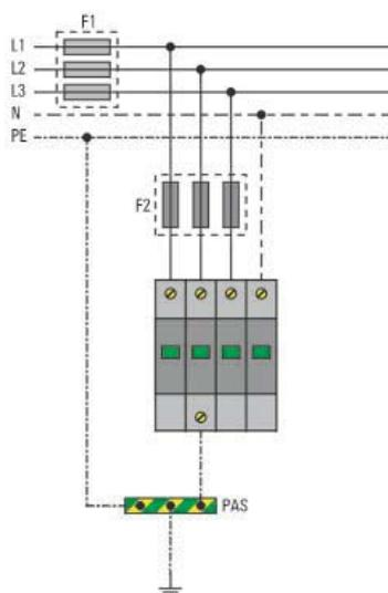
Устройства VPU I LCF могут устанавливаться перед счетчиком. В стандарте VDE 0100 часть 534 "Выбор и монтаж оборудования" приводится описание монтажа установок с устройствами защиты от перенапряжения. Этот стандарт взаимосвязан со следующими стандартами:
