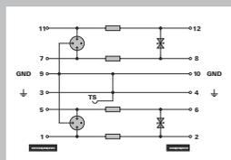
Сигналы от токовых петель (аналоговые измерения от датчиков для передачи на большие расстояния) 4 ... 20 мА, 0 ... 20 мА и т. д., например, измерения уровня.
