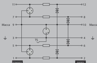
Комплектный модуль, непрямого заземления
