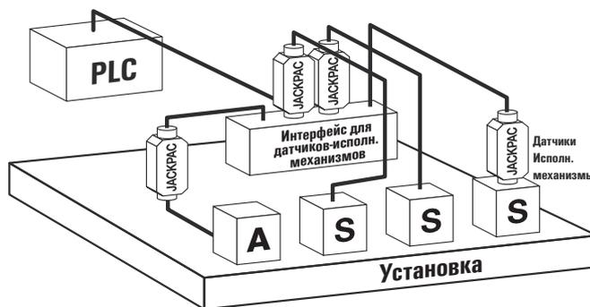
обеспечивает возможность инновационных концепций автоматизации на основе децентрализации – без больших шкафов управления или небольших распределительных щитов – для прозрачных, эффективных и экономичных установок.
