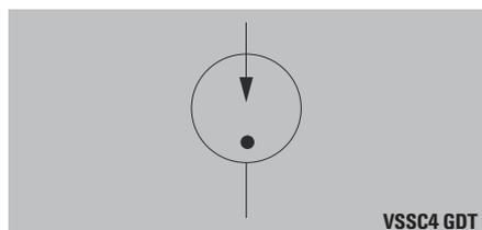
Устройство **VSSC4 GDT** обеспечивает одноступенчатую защиту с газоразрядной трубкой (GDT) для цепи тока на контакт PE. **VSSC4 GDT** ограничивает перенапряжение в **одной цепи**. Эта клемма используется в тех случаях, когда не допускается утечка тока на землю, или экран кабеля с высоким импедансом соединен на землю. Газоразрядная трубка GDT предлагается на напряжения 90 В, 110 В и 240 В.
