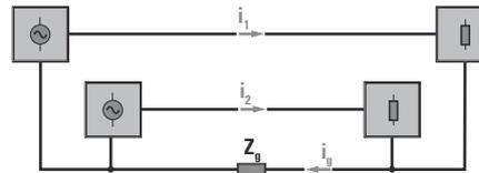
Перенапряжения передаются напрямую в цепи через общие импедансы заземления. Величина перенапряжения зависит от силы тока при грозовом разряде и условий заземления. Частота и форма волны, главным образом, определяются индуктивностью и скоростью нарастания тока. Даже далекие грозовые разряды могут вызывать перенапряжения в форме бегущих волн, которые отрицательно влияют на работу различных частей электрических систем посредством резистивной связи.
