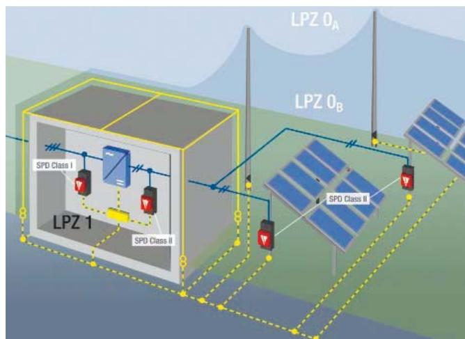
Рис. 3: Полевая установка с наружной системой молниезащиты
