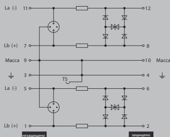
Комплектный модуль, прямое заземление
