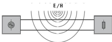
Поля электромагнитных волн (поля E/H), которые также создаются во время грозового разряда (состояние удаленного поля, векторы поля E/H перпендикулярны друг другу), влияют на структуру проводников таким образом, что связанных перенапряжений следует ожидать даже при отсутствии прямых грозовых разрядов. Постоянные волновые поля от передатчиков большой мощности также способны вызывать связанные напряжения помех в линиях и цепях.
