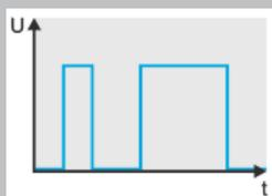
Двухпроводная схема, обычно с общим опорным потенциалом, например, сигналы от двоичных датчиков, исполнительных механизмов и индикаторов, таких как концевые выключатели, щупы, датчики положения, фотоэлектрические барьеры, контакторы, электромагнитные клапаны, сигнальные лампы.
