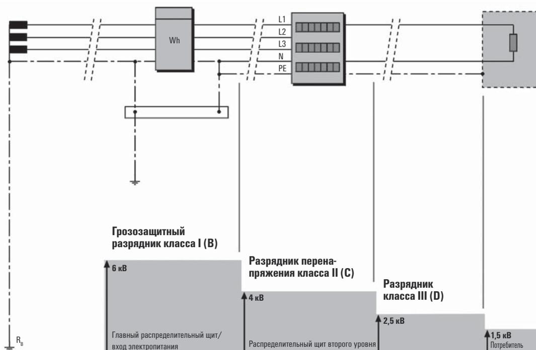
Расчетное импульсное перенапряжение при напряжении проводник-земление 300 В
