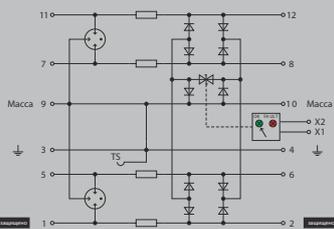
Комплектный модуль, прямое заземление, с дистанц. оповещением
