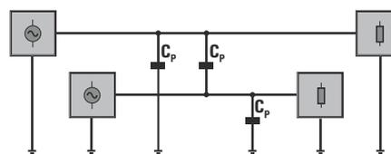
Емкостная связь перенапряжений также возможна. Высокое напряжение грозового разряда создает электрическое поле высокой напряженности. Перенос электронов может вызвать уменьшение емкости цепей с более низкими потенциалами и привести к повышению соответствующего потенциала до уровня перенапряжения.
