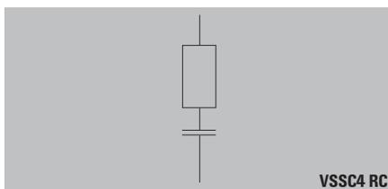
**VSSC4 RC** является последним вариантом защиты в серии VSSC. Этот вариант сочетает варистор с тепловым контролем и комбинацию RC. Он может использоваться для искрогашения на индуктивных нагрузках. VSSC4 RC предлагается с напряжениями 24 В и 240 В.
