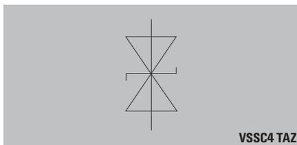
Устройство **VSSC4 TAZ** обеспечивает одноступенчатую защиту с оградительным диодом (TAZ) с быстрой реакцией (<10 нс) для цепи тока на контакт PE. **VSSC4 TAZ** ограничивает перенапряжение в **одной цепи** (например, для цифровых входных сигналов). Диод TAZ предлагается на напряжения 12 В, 24 В, 48 В и 60 В.
