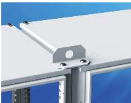
Предназначен для равномерного распределения силы подъема при транспортировке двух соединенных напольных распределительных шкафов с помощью крана. Легко монтируется в резьбовые отверстия рамы, предназначенные для крепления потолочной панели, диаметр резьбы 12 мм.. Предельно допустимая статическая нагрузка 500 кг при транспортировке под углом 60°
