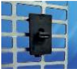
Для крепления кабельных каналов на монтажных сетках MN с прямоугольной перфорацией 26x11 мм. Также устанавливается на DIN-рейках 35 мм. Полный аналог NSYSPC.
