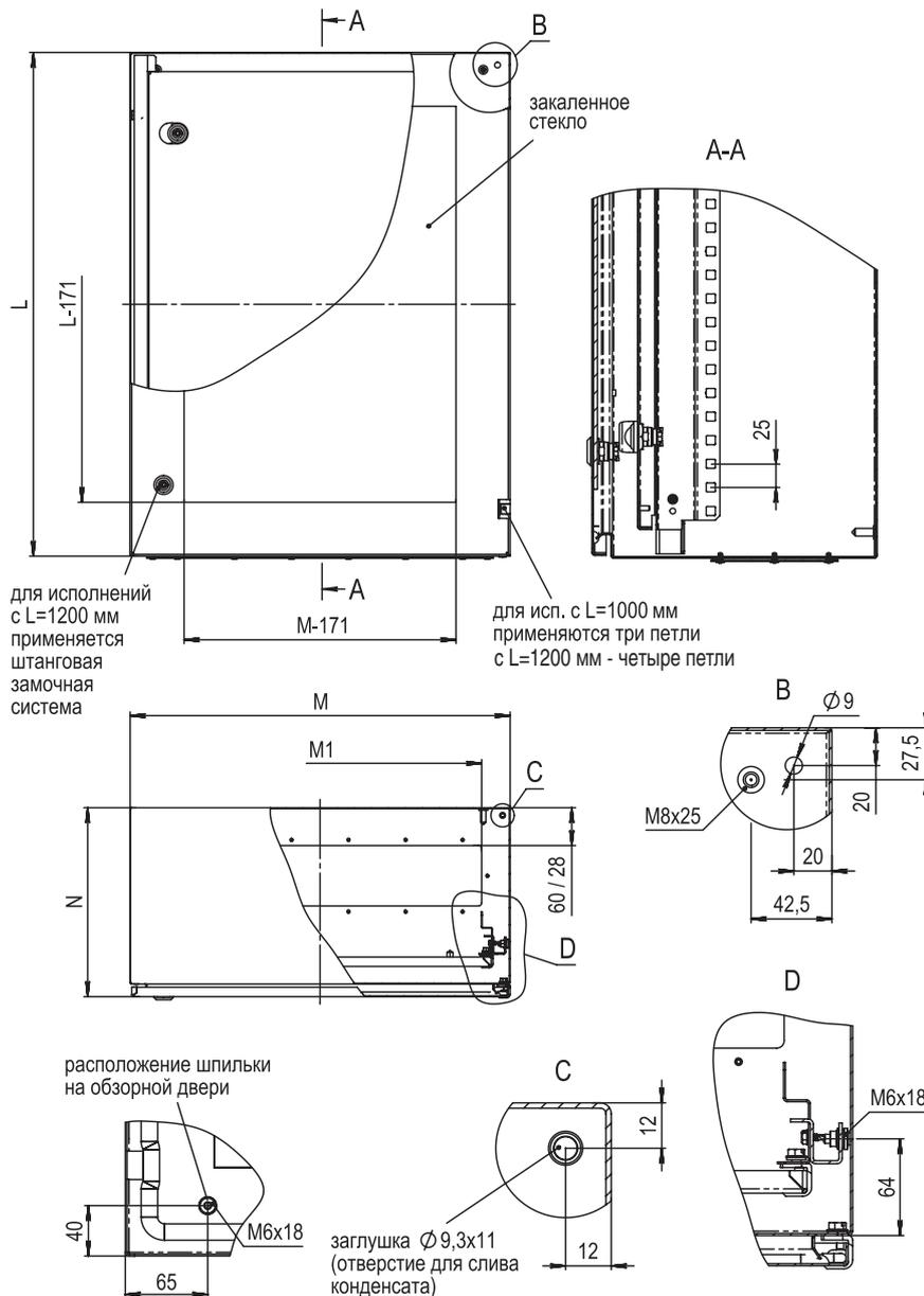
\* – штанговая система для корпусов высотой 1200, 1400, 1600 мм
