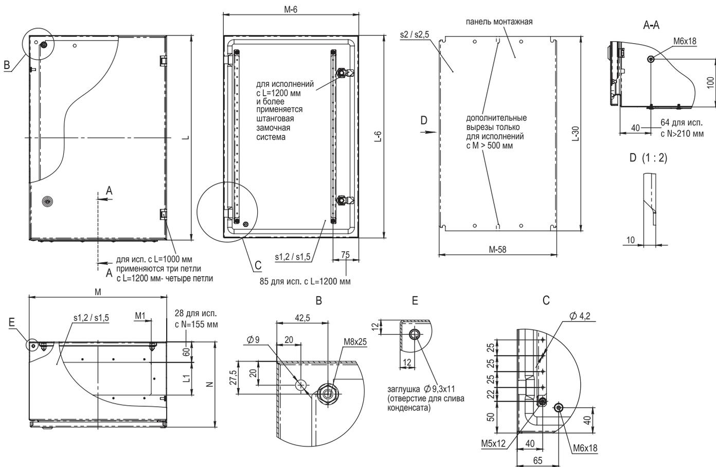
\* – 1,2 мм для корпусов глубиной менее 210 мм
