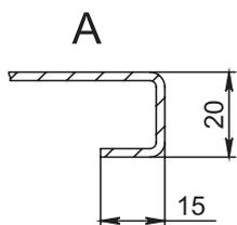
Монтаж панели к раме осуществляется при помощи самонарезающих винтов через кронштейны монтажной панели
