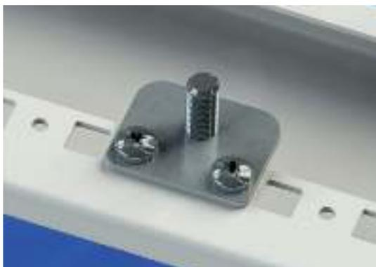
Для подключения проводов заземления к вертикальному и горизонтальному профилю шкафа. Соединительная пластина крепится двумя саморезами к раме шкафа, чем обеспечивается надежный контакт. Подключение заземления осуществляется через резьбовую шпильку М8 х 20 мм..
