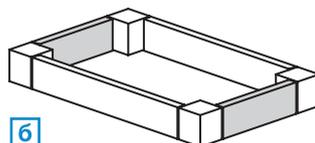
Предназначен для монтажа к полу настенных корпусов для средств автоматизации, напольных распределительных шкафов, нижних частей пультов. Высота цоколя 100, 200 мм. Состоит из передних, задних и боковых элементов
