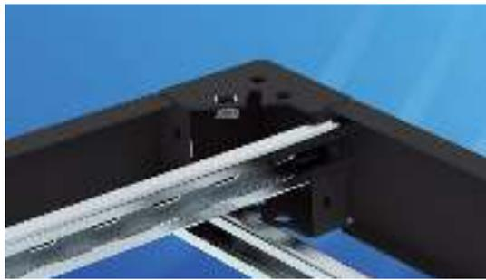
Есть возможность осуществлять фиксацию кабелей в цоколе шкафа при помощи монтажных траверс (заказываются отдельно, см. стр. 132) через закладные гайки М6 (заказываются отдельно, см.стр. 200), которые устанавливаются в предусмотренные для этого отверстия в углах цоколя.
