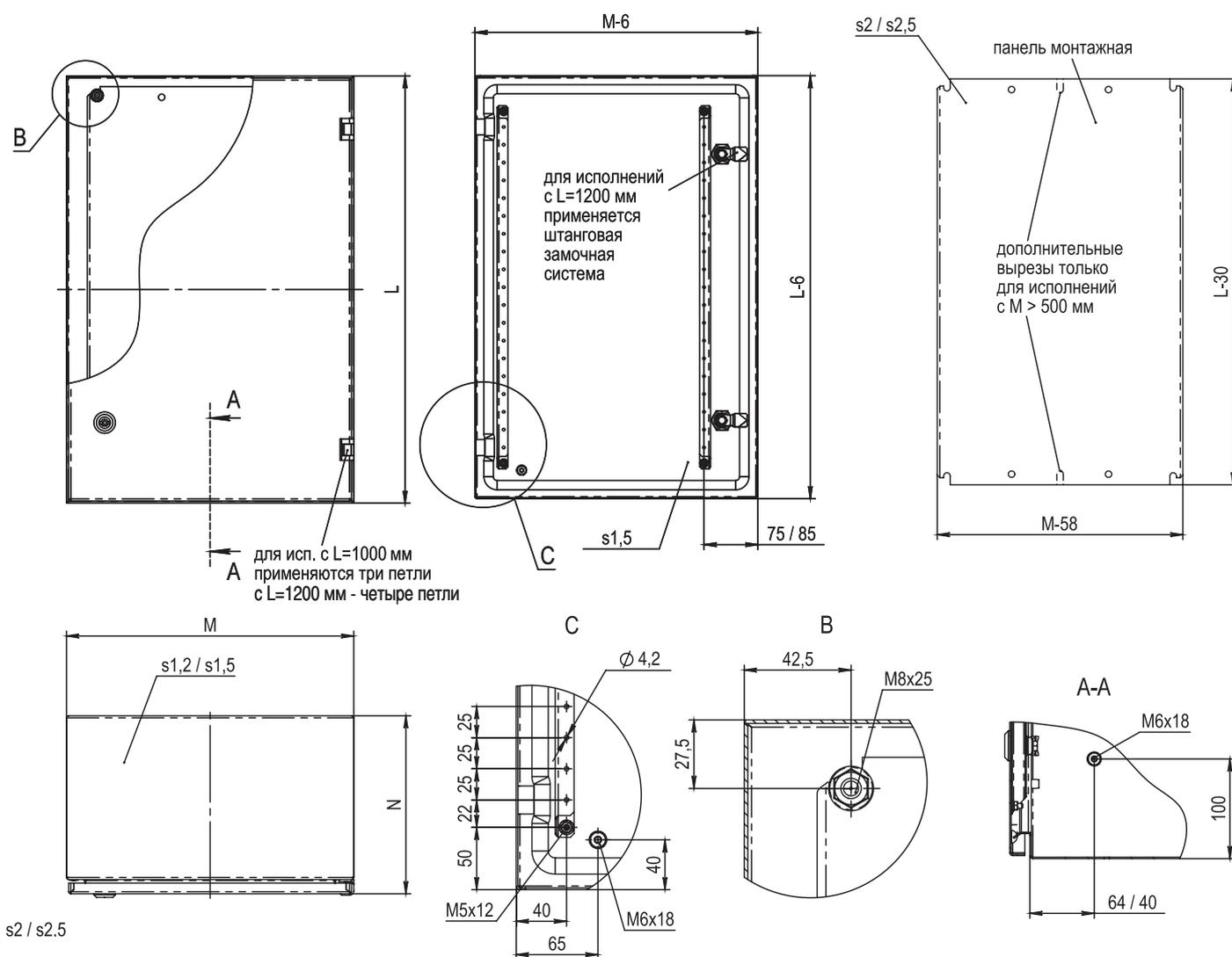
\* – 1,2 мм для корпусов шириной менее 800 мм
