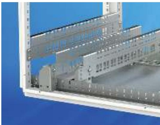
Предназначена для разводки и разгрузки от натяжения с возможностью контакта ЭМС входящих и отходящих кабелей посредством кабельных зажимов. Регулирование установки с шагом 25 мм. Крепится непосредственно к раме шкафа или через держатели траверсы В 8 МГ (заказываются отдельно, см. стр. 131). В рейке имеются два отверстия для дополнительного контакта.
