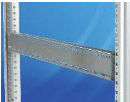
Предназначена для регулирования установки оборудования по глубине, ширине и высоте напольного распределительного шкафа. На рейке выполнена овальная и круглая перфорация под крепёжные винты S 6.(X) MX с использованием гаек с фланцем N 6 MF, а также самонарезающие винты. Крепится к раме шкафа во внутренней и наружной плоскости и/ или к другим рейкам с использованием двух кронштейнов, входящих в комплект поставки. Используется в составе шкафов MPP и рам MF X.Y.60IT.
