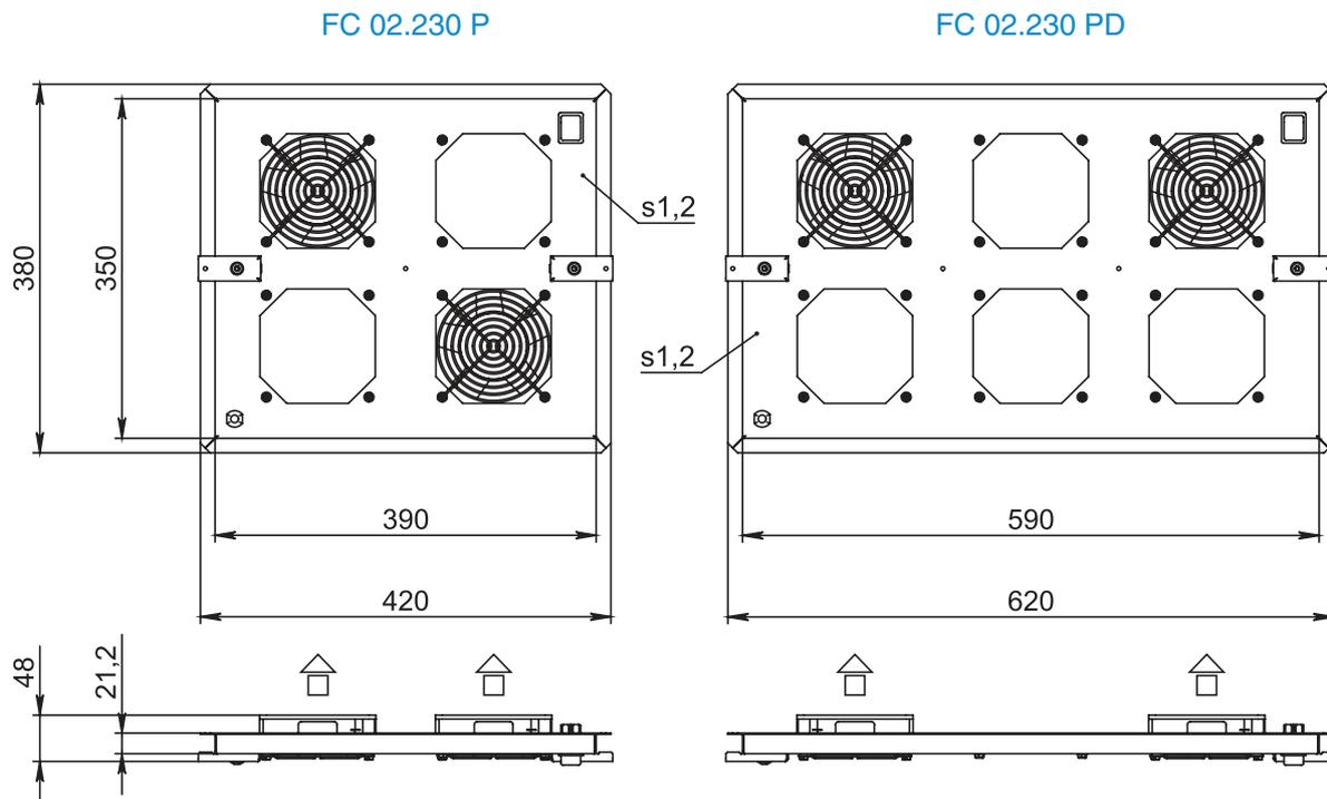
для сетевых и телекоммуникационных шкафов типа IPx - устанавливается в подготовленный проем рамы IP, крепление с помощью закладных гаек и винтов M5/M6
