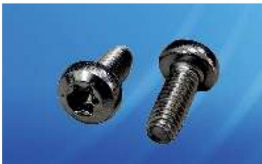
Резьбовыдавливающий винт – головка под torx T25. Размер M5x12 мм, при заворачивании в отверстия 4,2-4,5 мм нарезает резьбу M5.
