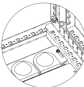
Панель с герметичными кабельными вводами (IP 55) устанавливается на раму шкафа вместо стандартной стационарной панели в основании рамы, стык необходимо проклеить с помощью самоклеющегося уплотнителя G 10.5 G или G 20.40 G.
