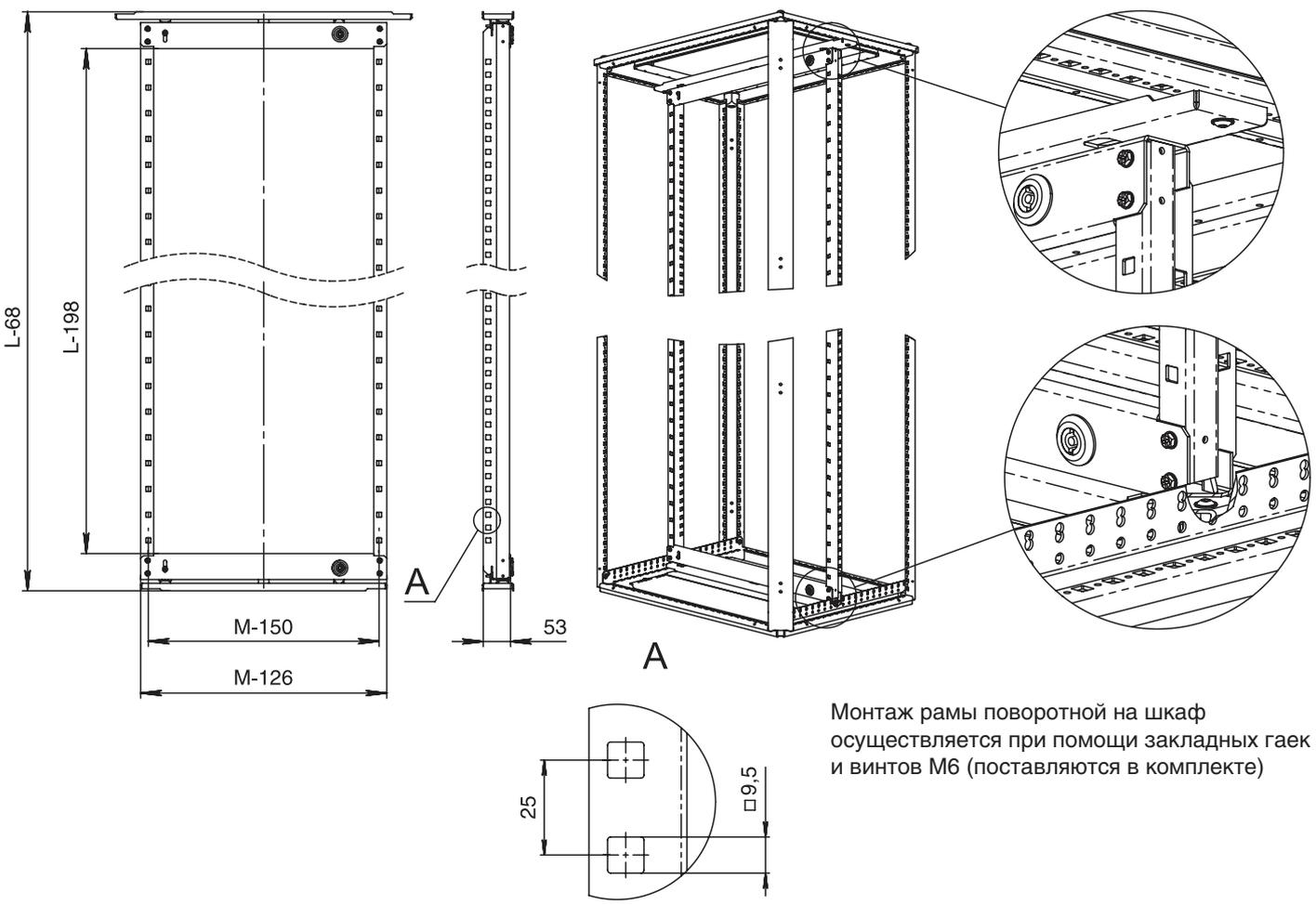
Монтаж рамы поворотной на шкаф осуществляется при помощи закладных гаек и винтов М6 (поставляются в комплекте)
