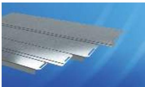
Предназначена для установки в напольные распределительные шкафы вместо элементов стандартной панели основания. Позволяет используя комбинации панелей организовать ввод кабеля в соответствии индивидуальными требованиями. Отдельная стационарная панель кабельного ввода с двух сторон отгибки по 19 мм для установки уплотнителя самоклеящегося G 20.40 G.
