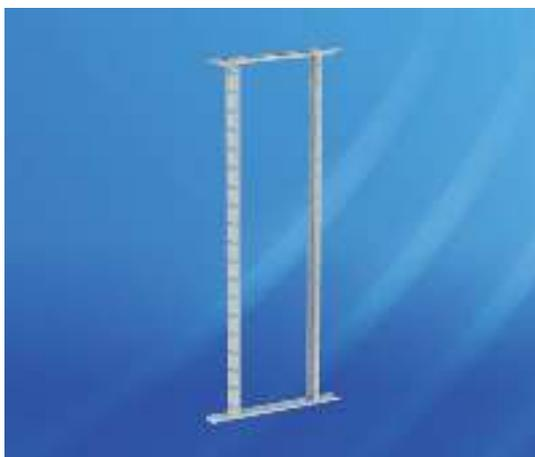
Предназначена для монтажа внутреннего оборудования 19" в напольных распределительных шкафах. Устанавливается только в шкафы шириной 800 мм. Монтаж к раме. Возможность регулировки по глубине. Предназначена для установки 19" оборудования с двух сторон.
