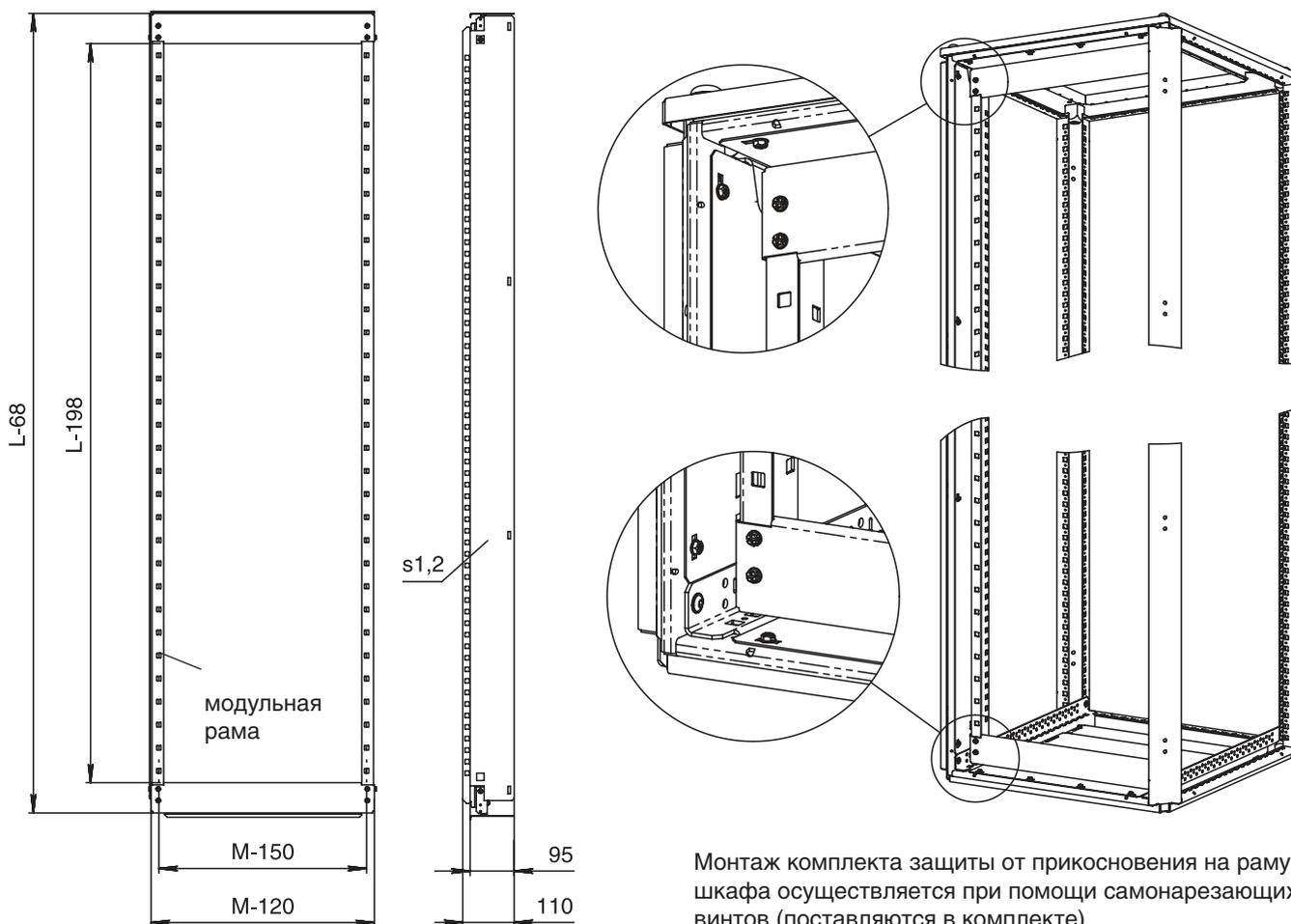
Монтаж комплекта защиты от прикосновения на раму шкафа осуществляется при помощи самонарезающих винтов (поставляются в комплекте)
