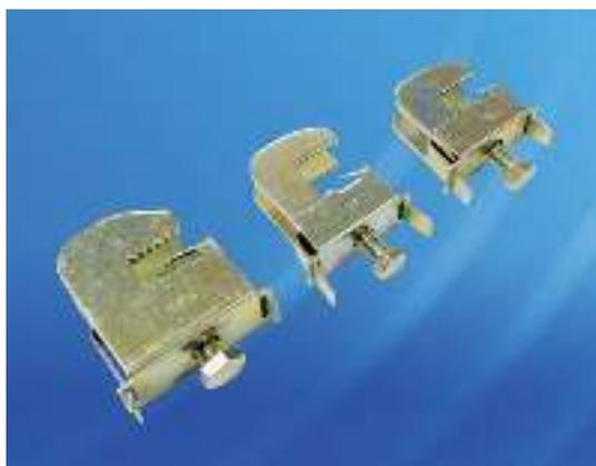
Универсальный зажим, предназначенный для подключения плоских шин, а также кабелей круглого сечения. Открытая клеммная камера и невыпадающий болт обеспечивают быстрый и простой монтаж
