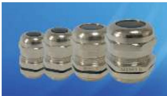
Кабельный ввод изготовлен из коррозионно-стойкой стали AISI 304 с резиновой мембраной и неопреновым уплотнителем. Равномерное обжатие и разгрузка от натяжения обеспечиваются за счет зажимных элементов, а неопрен гарантирует оптимальную герметизацию в месте крепления к корпусу.
