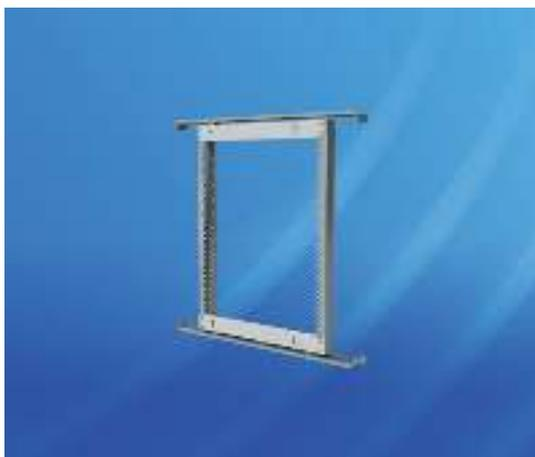
Предназначена для монтажа внутреннего оборудования 19" в напольных распределительных шкафах. Устанавливается только в шкафы шириной 800 мм. Монтаж производится на монтажные рейки, установленные по глубине шкафа. Возможно регулирование установки по глубине. Блокировка производится двумя замками под ключ с двойной бордкой 5 мм. Право или левостороннее открывание.
