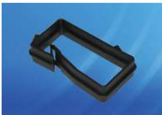
Предназначен для распределения патч-кабелей. Быстрое и легкое крепление в квадратные отверстия 9,5 мм под закладные гайки. Горизонтальное или вертикальное расположение.
