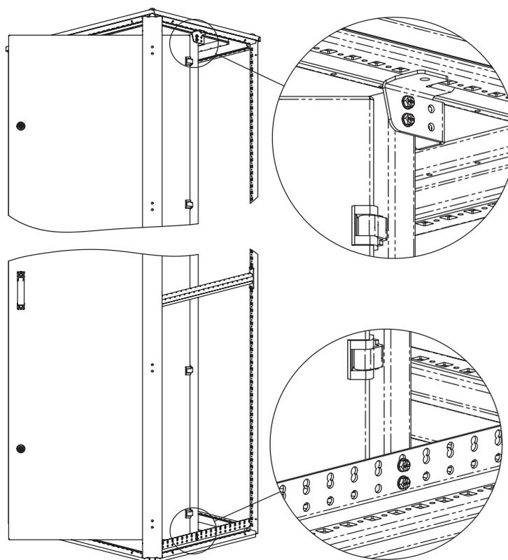
Монтаж профиля двери на раму шкафа осуществляется при помощи самонарезающих винтов (поставляются в комплекте)
