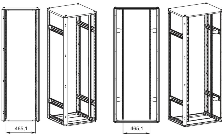
Установка вертикальных реек 19" на раму напольного шкафа осуществляется совместно с монтажными рейками MG L v.2 (см. стр. 212)
