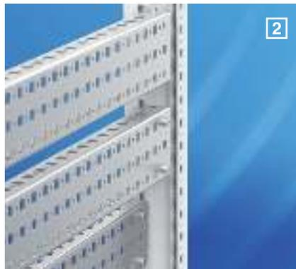
Предназначена для регулирования установки оборудования по глубине, ширине и высоте напольного распределительного шкафа. Крепление оборудования к рейке возможно с помощью закладных гаек и/или самонарезающих винтов. Крепится рейка к раме шкафа и/или другим рейкам.
