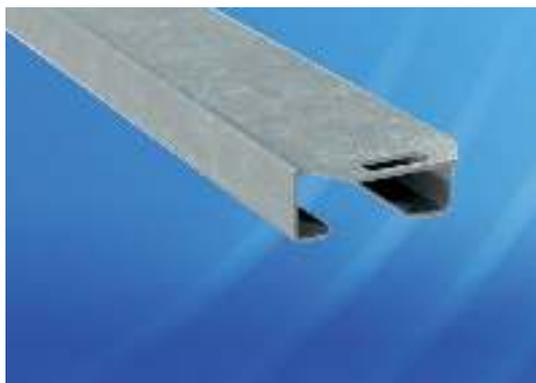
Узкая панель кабельного ввода шириной 45 мм для замены стандартных панелей (шириной 67 и 177 мм). К боковым отгибкам панели можно закрепить щеточный ввод G X.4 B или губчатый ввод G 20.40 G.
