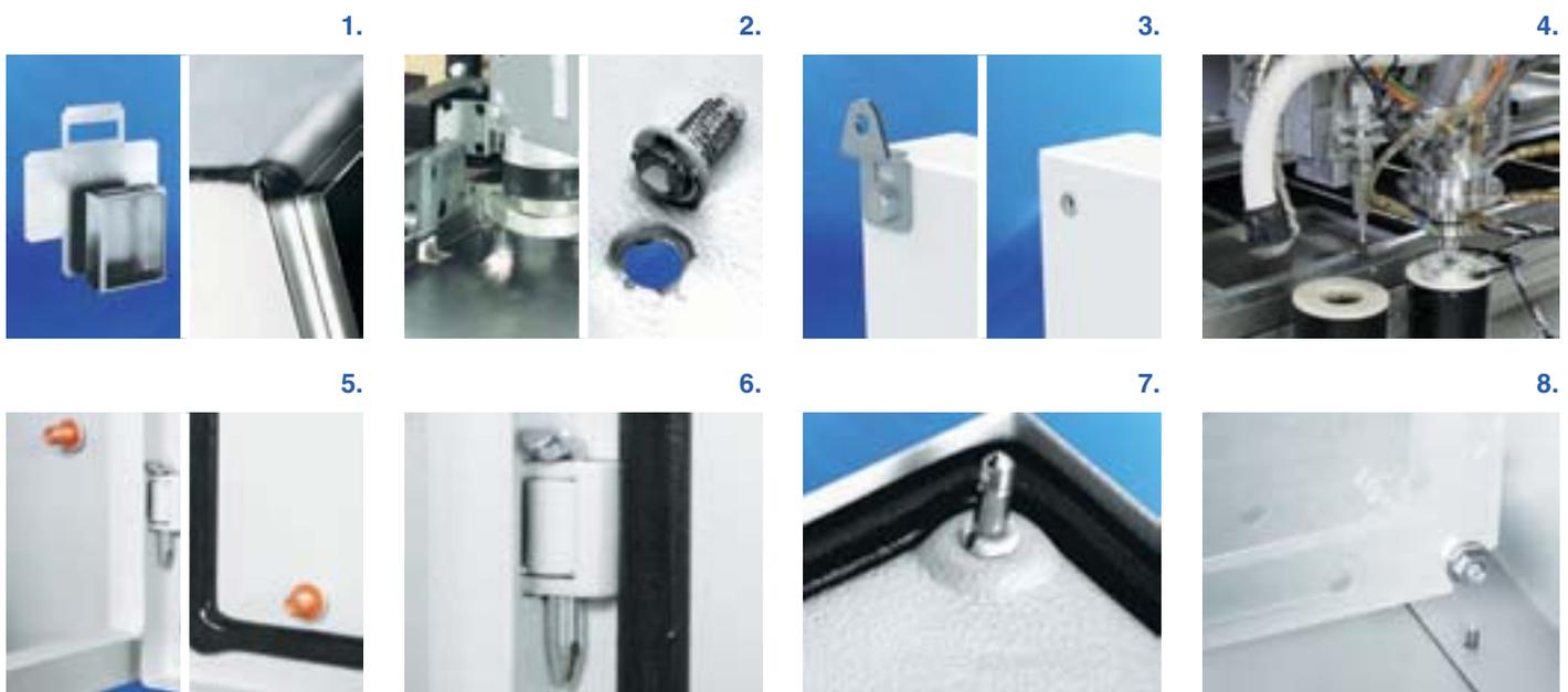
**1.** Корпус выполнен из одного листа стали. Стыки корпуса сварены непрерывным циклом для придания жесткости и плотности. Желоб по краю корпуса обеспечивает дополнительную жесткость корпуса и препятствует попаданию грязи и воды внутрь при открытии шкафа.
