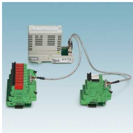
Схема подключения FLKM-D25 SUB/B/KDS3-MT/TU810
