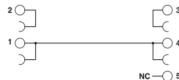
Схема подключения PLC-VT
