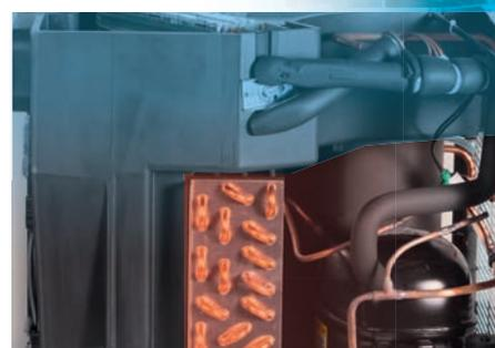
Инновационное расположение холодной части охлаждающего устройства над теплой обеспечивает предотвращение накопления конденсата внутри корпуса.
