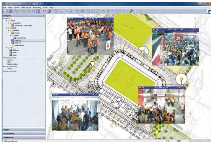
На плане здания затем указываются камеры, например, из списка видеисточников. Камеры отображаются в виде **окон или символов.** Такой интерфейс прост, удобен и позволяет отказаться от трудоемкого поиска камер в длинном списке.
