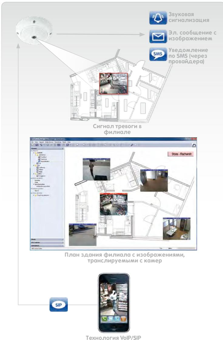
Камера MOBOTIX зарегистрировала проникновение вломщика и включила сигнализацию
