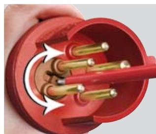
**Фазоинвертор** Оперативное изменение направления вращающегося трехфазного поля (в изделиях на токи 16-32А). Фазировка меняется с помощью одного поворота отвертки!
