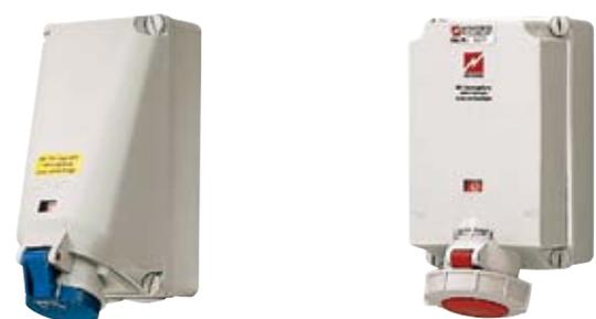
Розетки с механической блокировкой DODSCH поставляются со степенью защиты оболочки IP 44, рассчитанные на токи 16А и 32А, а токи же со степенью защиты оболочки IP 55, рассчитанные на токи 16А, 32А и 63А.
