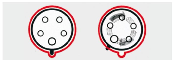
Без рукоятки выключателя. Достаточно одного движения: вставить вилку, повернуть по часовой стрелке (= включить) или, повернув в обратном направлении (= выключить), извлечь вилку.
