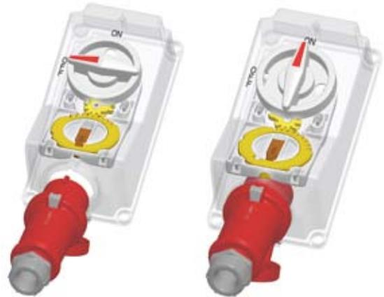
После соединения разъема и подачи напряжения блокируется вилка. После отключения напряжения и отсоединения вилки блокируется выключатель.
