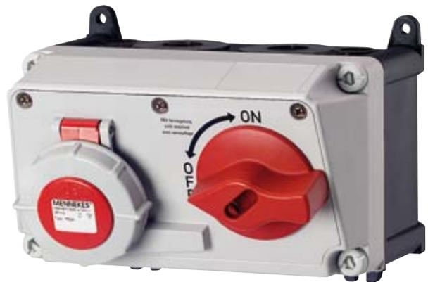
Все розетки с механической блокировкой DUO, рассчитанные на ток до 63А включительно, оснащены проушиной для навесного замка, которая в положении OFF позволяет предотвратить несанкционированное включение. Розетки с блокировкой DUO, рассчитанные на 125А, по заказу могут поставляться
