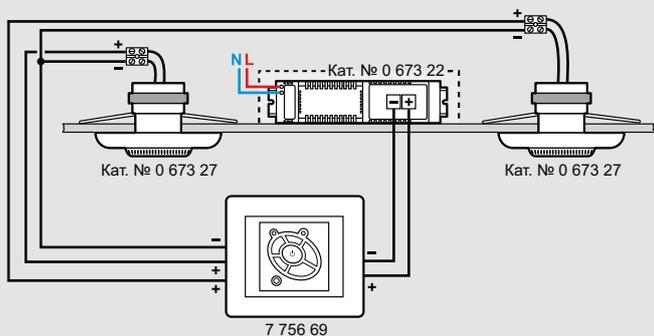
FM-тюнер стерео Кат. № 7 756 69 + блок питания для тюнера со встроенной колонкой Кат. № 7 756 74 (моно)
