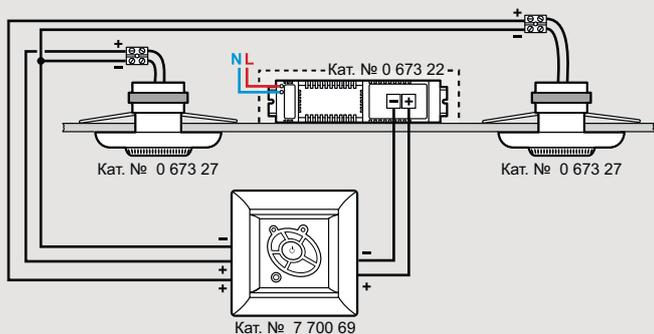
С помощью стерео FM-тюнера Кат. № 7 700 69 + источником питания со встроенной колонкой Кат. № 7 700 70 (моно)
