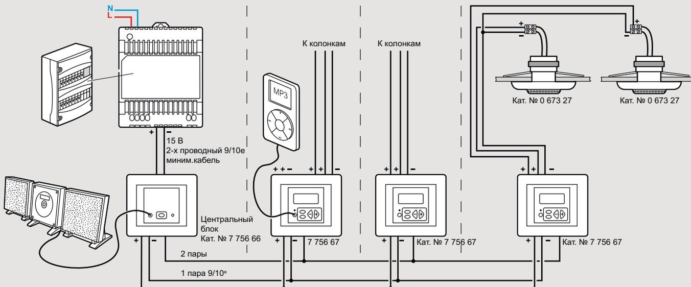
Трансляция от основного источника, дополнительного источника (MP3-плеер) или независимого радио через устройство локального управления Кат. № 7 756 67 и расширение тюнера Кат. № 7 756 68
