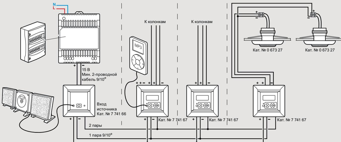
Трансляция звука из центрального источника, вспомогательного источника (MP3-плеера) или автономного FM-радиоприемника с помощью локального модуля управления Кат. № 7 741 67/7 700 67/7 702 67 и FM-тюнера Кат. № 7 741 68/7 700 68/7 702 68
