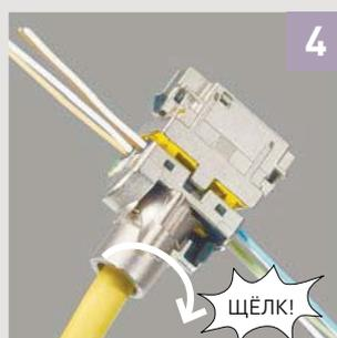
**4 Поверните фиксатор для гарантированного подключения**
