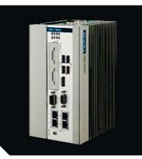
Промышленный сервер с расширенным температурным диапазоном обеспечивает работу системы управления освещением ME6. Монтируется на DIN-рейку в шкаф управления. В качестве резервного канала связи предусматривается использование сети GSM: 3G/4G.
