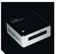
Локальный сервер визуализации, управления и конфигурации беспроводной системы управления освещением ME6.
