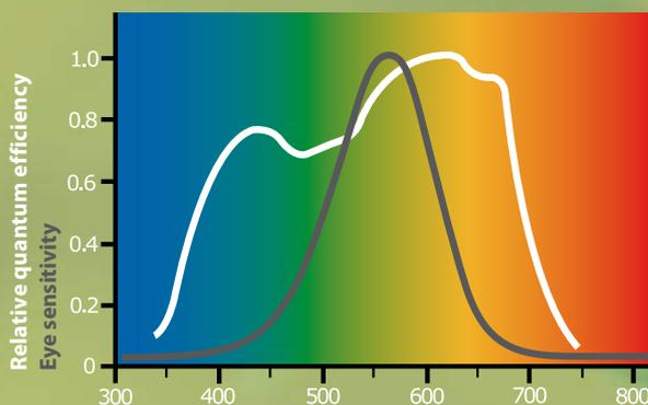
Число фотонов или свет для роста, генерированный источником света, определяется как параметр ППФ (анг. Photosynthetic Photon Flux - струя фотонов фотосинтеза). Интенсивность освещения при определенном расстоянии от источника света (примерно при высоте растений) - сумма света для роста на м<sup>2</sup> выражена в микромолях/м<sup>2</sup>/с1.
