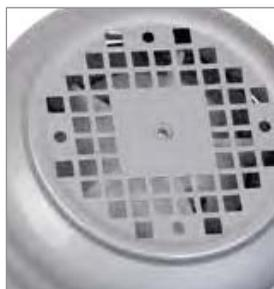
Надёжность системы охлаждения обеспечивается вентилятором охлаждения электродвигателя, расположенным на валу двигателя. Кожух вентилятора сделан из металла, обеспечивающего надёжную защиту от механических повреждений.
