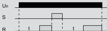
Диаграмма работы реле задержки включения ORT-A
