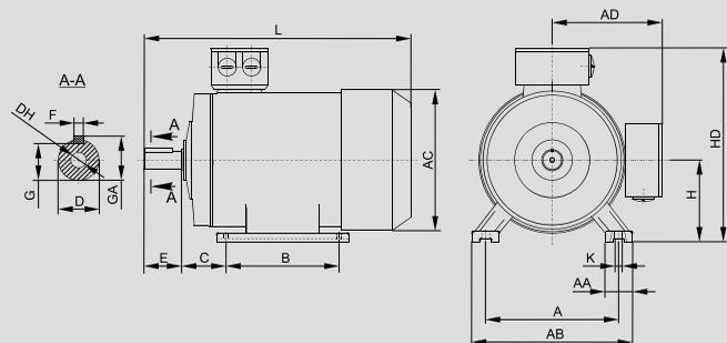
Размеры двигателей габаритов 180–355 монтажного исполнения IM 2081
