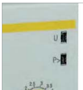
Световой индикатор показывает состояние сети.
