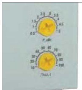
На лицевой панели – регуляторы ограничения мощности и времени включения нагрузки.
