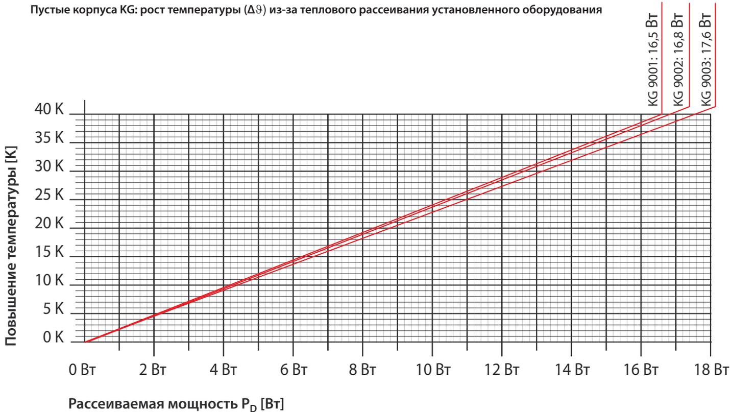
Пустые корпуса K: рост температуры ( $\Delta\theta$ ) из-за теплового рассеивания установленного оборудования
