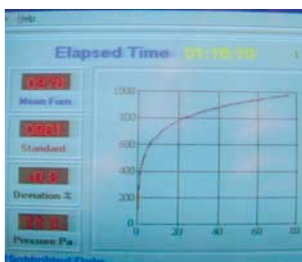
График температурных испытаний в соответствии с DIN 4102
