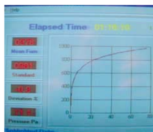
График температурных испытаний в соответствии с DIN 4102
