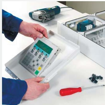
Пластрон вставляется и фиксируется сзади на раме дверцы.
