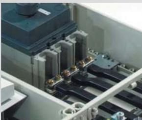
На контактах M 10 можно установить клеммы для подключения гибких шин VA 400 или клеммы прямого подключения DA 240 и DA 185 для подключения гибкой шины или медного/алюминиевого провода.
