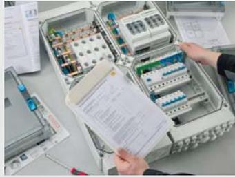
Изготовитель должен указать меры для поддержания защиты, которые должны быть реализованы. Проверить, чтобы прокладки и крышки были смонтированы в соответствии с данными изготовителя.
