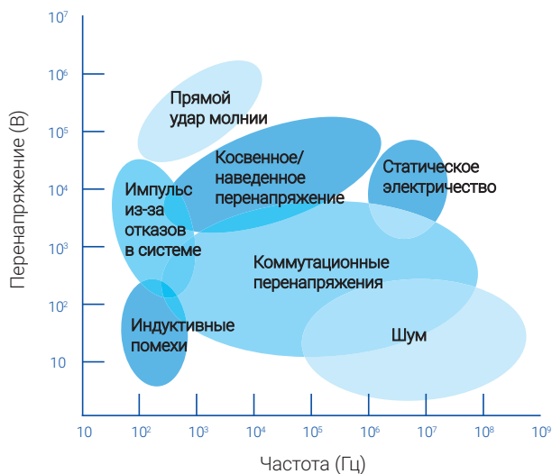
Рис. 1 Различные источники импульсов перенапряжения
