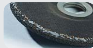
Обработка алюминия без RS3 (поры забиты)
