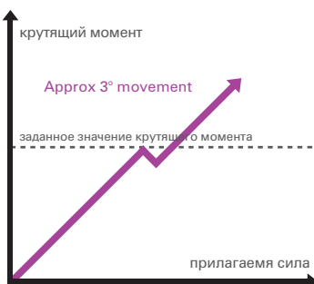
Трещоточный инструмент (перезатяжка вероятна)
