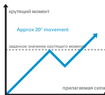
Останавливающийся инструмент (перезатяжка маловероятна)
