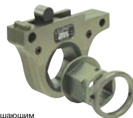
Сменная кассета с уменьшающим шестигранником и горловым кольцом
