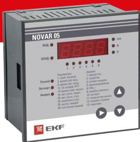
Регуляторы KPM NOVAR EKF PROxima измеряют коэффициент мощности сети и управляют включением косинусных конденсаторов для удержания оптимального коэффициента мощности. Приборы обладают большим количеством функций. Регуляторы способны измерять гармонические искажения вплоть до 19 гармоник и защищать конденсаторы при увеличении допустимых значений сети.
