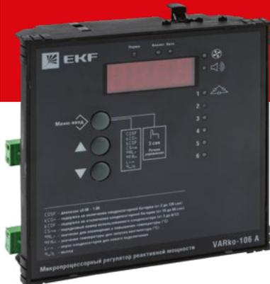
Регуляторы КРМ VARko EKF PROxima измеряют коэффициент мощности сети и управляют включением косинусных конденсаторов для удержания оптимального коэффициента мощности. При этом работа конденсаторов происходит таким образом, что в очередной раз подключаются конденсаторы с наименьшим временем работы, так увеличивается срок службы всей установки компенсации реактивной мощности.
