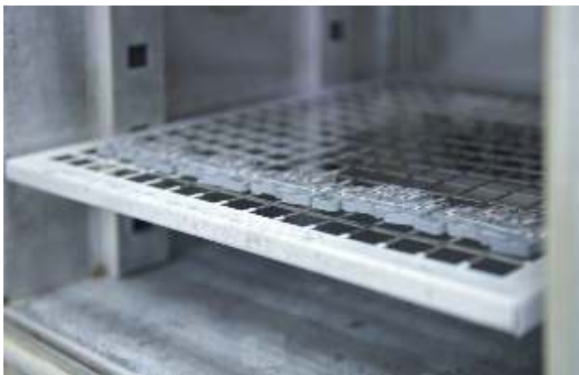
Циклические температурные испытания клемм на DIN-рейку
