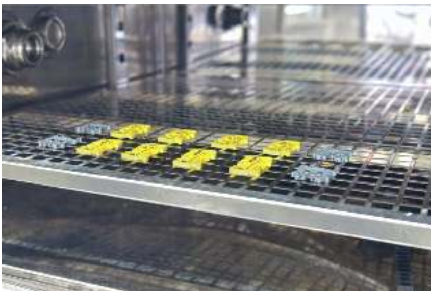
Циклические температурные испытания клемм на DIN-рейку
