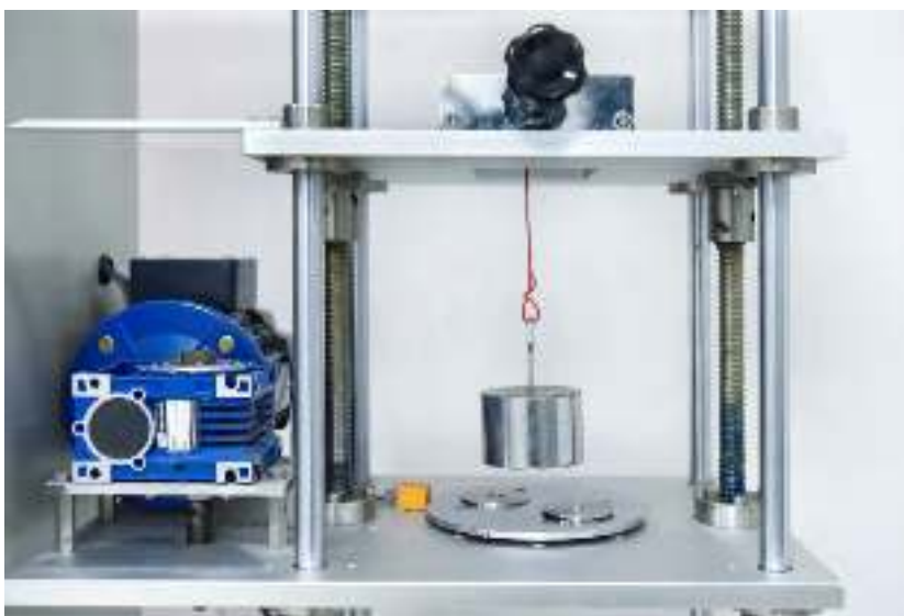
Испытание клемм на отрыв в зафиксированном положении
