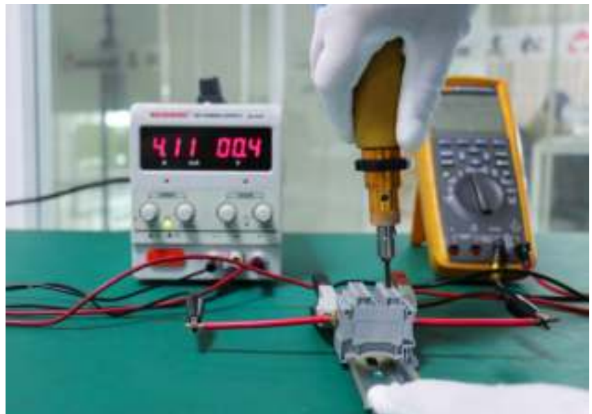
Din Rail Terminal Torque Test
