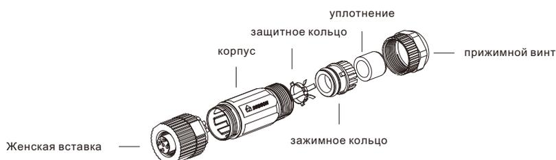
M12 x 1 гнездовой монтажный штекер, экранированный, соединение под пайку, Прямой.
