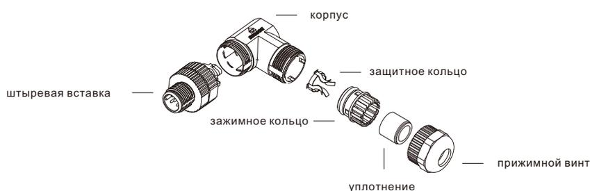
M12 x 1 гнездовой монтажный штекер, экранированный, с винтовым соединением, угловой.
