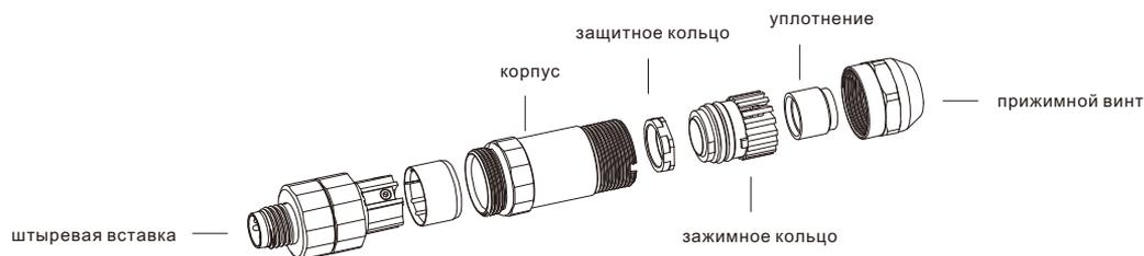
Кабельная розетка M8 x 1, экранированная, с винтовым соединением, прямая.
