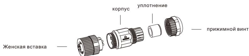
M12 x 1 гнездовой монтажный штекер, неэкранированный, соединение под пайку, Прямой.
