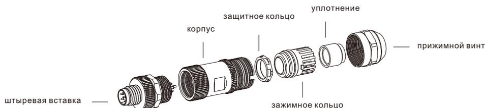
Кабельная розетка M8 x 1 с внутренней резьбой. Экранированный, соединение под пайку, прямой.
