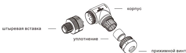
M12 x 1 гнездовой монтажный штекер, неэкранированный, соединение под пайку, Угловой.
