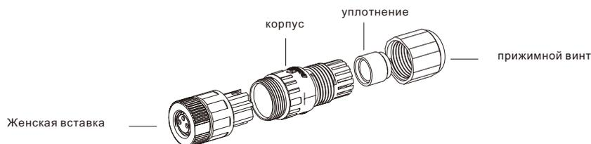
Штекер M8 x 1 с наружной резьбой, экранированный, с винтовым соединением, прямой.
