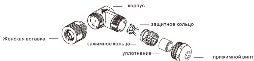
M12 x 1 гнездовой монтажный штекер, экранированный, соединение под пайку, Прямой.
