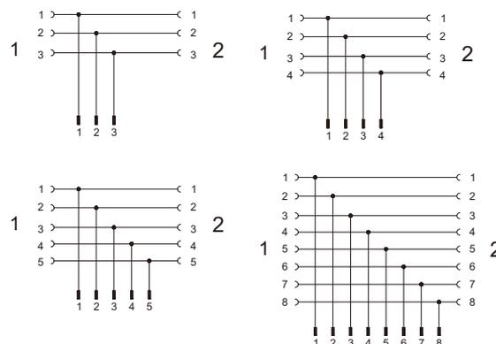
M12 Y-тип распределитель, M12 A вилка X1, M12 A розетка X2.
