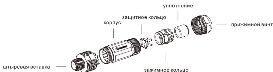
M12 x 1 гнездовой монтажный штекер, экранированный, с винтовым соединением, прямой.
