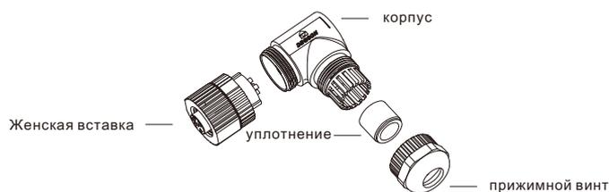
M12 x 1 гнездовой монтажный штекер, неэкранированный, соединение под пайку, Угловой.
