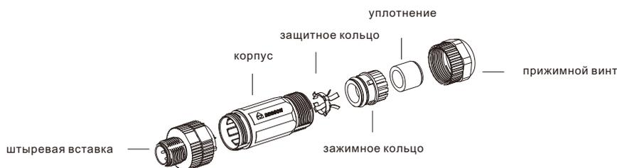
M12 x 1 гнездовой монтажный штекер, экранированный, соединение под пайку, Прямой.
