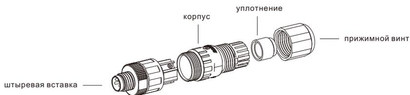
Кабельная розетка M8 x 1 для полевого монтажа, неэкранированная, с винтовым соединением, прямая.
