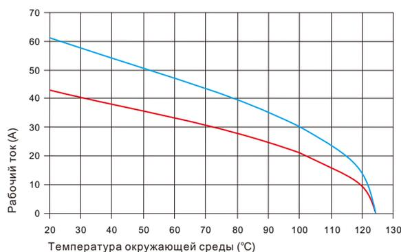
— 24В блочные/кабельные корпуса на 6 модуля, сечение провода: 10мм<sup>2</sup>
