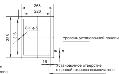
Размеры отверстия в оперативной панели
