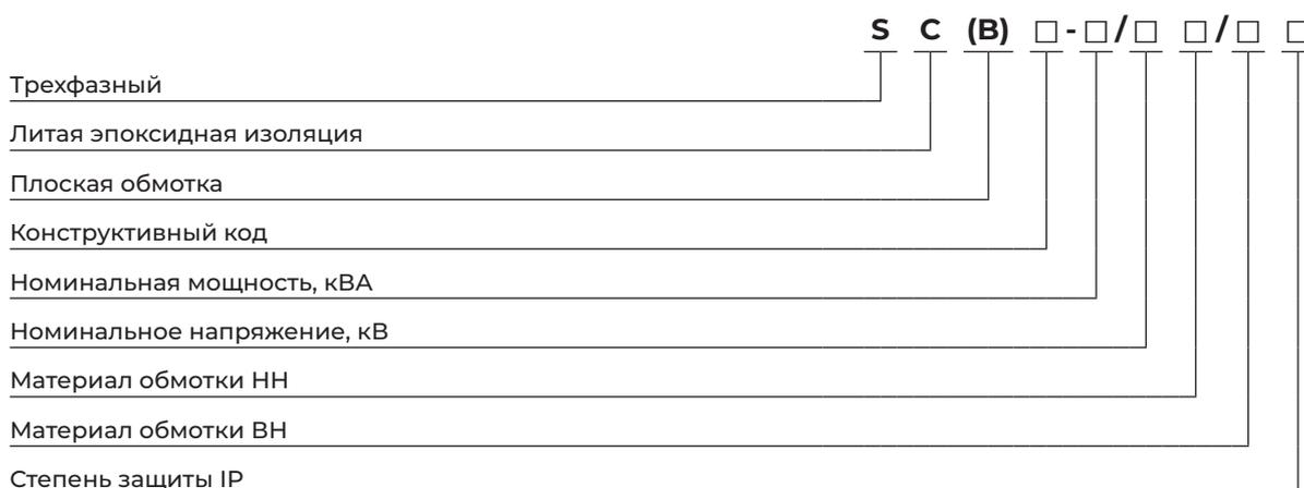
**Пример записи:** SCB10 1000/10 Al/Al IP00 – силовой сухой трансформатор с литой изоляцией класса F серии SCB10, на номинальное напряжение 12 кВ, мощностью 1000 кВА, материал обмоток высокого и низкого напряжения из алюминия, степень защиты IP00.
