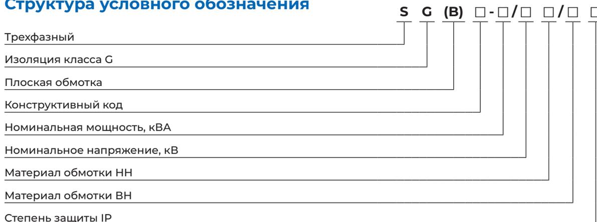
**Пример записи:** SGB10 2000/10 Cu/Cu IP31 – силовой сухой трансформатор серии SGB с воздушно-барьерной изоляцией класса H, на номинальное напряжение 12 кВ, мощностью 2000 кВА, материал обмоток высокого и низкого напряжения из меди, степень защиты IP31 в защитном кожухе.
