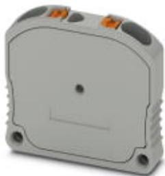
Проходная микроклемма, возможность отвода для 3,2 мм пробников, тип подключения: Зажимы Push-in, количество точек подсоединения: 2, сечение: 0,14 мм<sup>2</sup> - 1,5 мм<sup>2</sup>, AWG: 26 - 16, ширина: 4,2 мм, высота: 17,5 мм, цвет: серый
