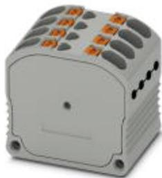
Микрораспределитель потенциалов, возможность отвода для 3,2 мм пробников, тип подключения: Зажимы Push-in, количество точек подсоединения: 6, сечение: 0,14 мм<sup>2</sup> - 1,5 мм<sup>2</sup>, AWG: 26 - 16, ширина: 12,6 мм, высота: 17,5 мм, цвет: серый
