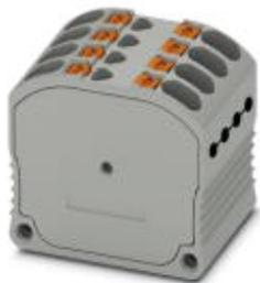
Микрораспределитель потенциалов, возможность отвода для 3,2 мм пробников, тип подключения: Зажимы Push-in, количество точек подсоединения: 4, сечение: 0,14 мм<sup>2</sup> - 1,5 мм<sup>2</sup>, AWG: 26 - 16, ширина: 8,4 мм, высота: 17,5 мм, цвет: серый
