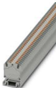
Проходная микроклемма, тип подключения: Зажимы Push-in, количество точек подсоединения: 2, сечение: 0,14 мм<sup>2</sup> - 1,5 мм<sup>2</sup>, AWG: 26 - 16, ширина: 4,2 мм, цвет: серый, тип монтажа: NS 15
