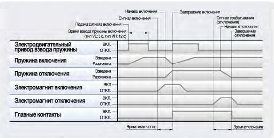
Последовательность состояний механизма автоматического выключателя
