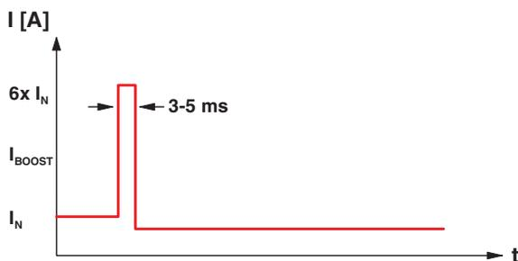
Рисунок 9 Быстрое срабатывание автоматических выключателей благодаря технологии SFB
