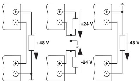
Рисунок 14 Последовательный режим работы
