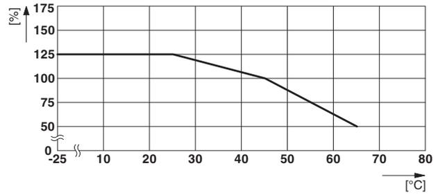
Монтажное положение с поворотом на 270° по оси X
