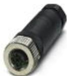
Силовой соединитель, 3-полюсн., Гнездо прямое M12, S-кодирование, Винтовые зажимы, материал накатанной гайки: Цинк. литья под давлением, с никелевым покрытием, кабельный ввод Pg9, наружный диаметр кабеля 6 мм ... 8 мм, для переменного тока до 16 A / 230 В
