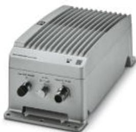
Источник питания TRIO POWER с регулированием в первичной цепи, в литом корпусе IP67, вход: 3-фазный, выход: 24 В DC / 20 А
