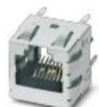
Гнездовая вставка для RJ45, конструкция: RJ45, степень защиты: IP20, полюсов: 8, 10 Гбит/с, тип подключения: Подключение пайкой
