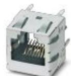
Гнездовая вставка для RJ45, конструкция: RJ45, степень защиты: IP20, полюсов: 8, 10 Гбит/с, тип подключения: Подключение пайкой
