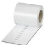
Маркировка для клеммных модулей, рулон, белый, без надписи, маркируется с помощью: THERMOMARK ROLL 2.0, THERMOMARK ROLL, THERMOMARK ROLL X1, THERMOMARK ROLLMASTER 300/600, THERMOMARK X1.2, THERMOMARK S1.1, с перфорацией, тип монтажа: Фиксация в универсальном пазу, крепление в плоских пазах для табличек, для клемм шириной: 5,2 мм, размер маркировочного поля: 6,4 x 5,15 мм, Количество отдельных табличек: 19000
