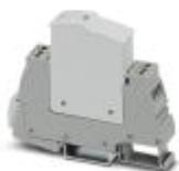
УЗИП типа 2/3, в комплектации из защитного штекера и базового элемента, со встроенным индикатором состояния и датчиком удаленного оповещения для однофазных электрических сетей. Номинальное напряжение 230 В AC/DC.
