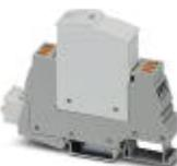
Устройство защиты от перенапряжений типа 2/3, состоит из защитного штекера и базового элемента с зажимом push-in. Для однофазных сетей питания со встроенным индикатором состояния и удаленным оповещением. Номинальное напряжение 230 В AC/DC.
