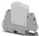
Устройство защиты от перенапряжений типа 2/3, состоит из защитного штекера и базового элемента с винтовым зажимом. Для однофазных сетей питания со встроенным индикатором состояния и удаленным оповещением. Номинальное напряжение 230 В AC/DC.
