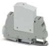
Устройство защиты от перенапряжений типа 2/3, состоит из защитного штекера и базового элемента с винтовым зажимом. Для однофазных сетей питания со встроенным индикатором состояния и удаленным оповещением. Номинальное напряжение 230 В AC/DC.
