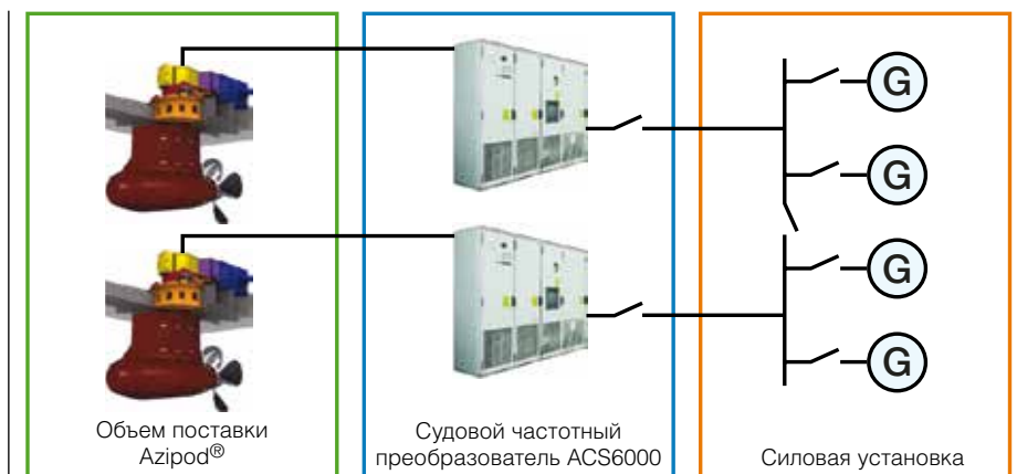
Рис. 2. Упрощенная однолинейная схема силовой установки и движительной системы
