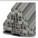
Многоярусный клеммный модуль, Сечение:  $0.2 \text{ мм}^2$  -  $10 \text{ мм}^2$ , AWG: 24 - 8, Тип подключения: Винтовые зажимы, Ширина: 8.2 мм, Цвет: серый, Тип монтажа: NS 35/7,5, NS 35/15
