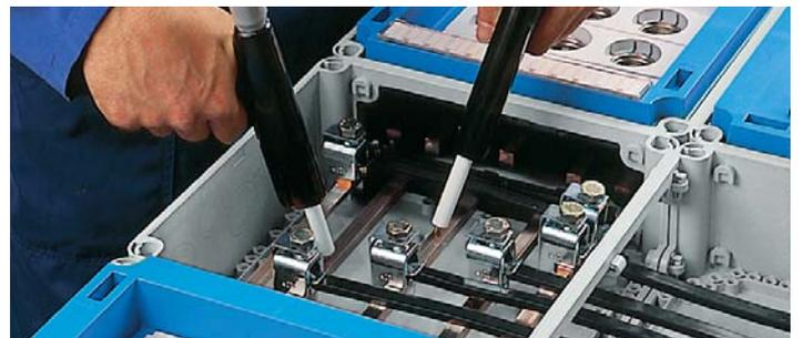
Необходимо проверить выдерживаемое напряжение промышленной частоты всех цепей в течение 1 с согласно ГОСТ Р МЭК 61439-1 раздел 10.9.2. Тестовое напряжение НКУ с номинальным напряжением изоляции 300–690 В пер. тока составляет 1890 В. Значения для тестирования при другом номинальном напряжении изоляции даны в таблице 8 в ГОСТ Р МЭК 61439-1.
